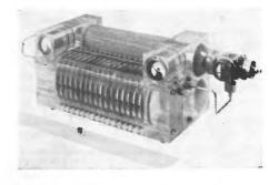
Esempio di realizzazione pratica di una pila a combustibile di cui è possibile apprezzare le dimensioni ridotte. Questo dispositivo è capace di fornire una potenza di circa 50 W funzionando a temperatura ambiente. (Documentaz. Co.G.E.).
