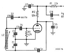
Fig. 4 - Oscillatore 90-100-107 MHz.
