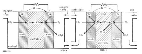
Fig. 1 - Sezione schematica di una pila a combustibile di modello classico. L'idrogeno si dissocia in elettroni i quali fluiscono attraverso il circuito esterno, ed in ioni che attraversano l'elettrolita e si combinano con l'ossigeno dando luogo alla formazione di acqua.
