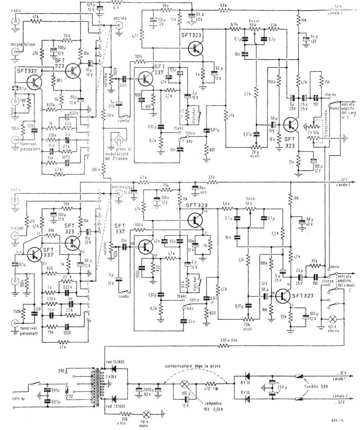
Fig. 1 - Schema di principio dei due preamplificatori e dell'alimentatore comune ai due canali
