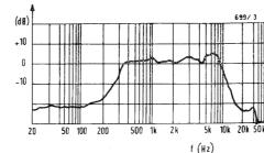
Fig. 2 - Curva di trasmissione acustica rilevata alimentando il « Médomex » attraverso il filtro divisore « Vega » (12 dB/ottava, a 60 Hz e a 5 kHz); le bande grave ed acuta sono caricate con resistenze di 15  $\Omega$ .
