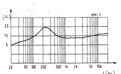
Fig. 3 - Curva dell'impedenza elettrica; alto-
