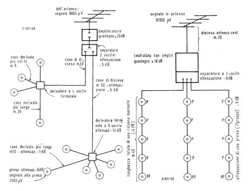
Fig. 31 - Esempio di calcolo delle attenuazioni e guadagni in un impianto elementare. Il totale dei dB è: +20-6-5-14-1-6=12 dB. Il segnale alla presa è  $\frac{1}{4}$  del segnale captato dall'antenna  $=2.000~\mu\text{V}$ .
