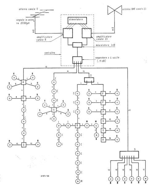
Fig. 35  $\alpha$  - Impianto centralizzato con rete di distribuzione mista per la ricezione del 1º programma sul canale B e 2º programma UHF (canale 23) per un totale di 51 prese.
