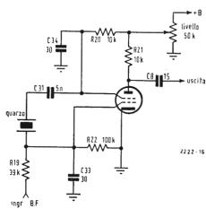
Fig. 5 - Oscillatore per marker.
