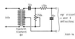
Fig. 11 - Circuito sfasatore.
