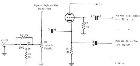
Fig. 8 - Separatore catodico d'uscita
