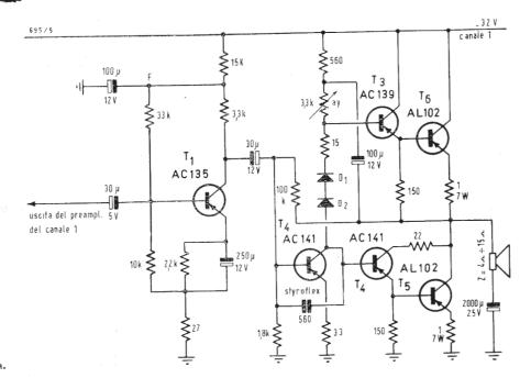
Fig. 1 bis - Schema di un amplificatore di potenza.
