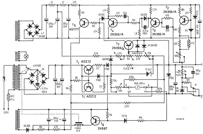
Fig. 2 - Schema elettrico dell'apparecchio.
