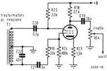
Fig. 6 - Oscillatore 400 Hz.
