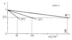
Fig. 2 - Il grafico quivi riprodotto pone in evidenza che la densità di corrente è funzione della temperatura di funzionamento della pila. Facciamo notare a questo proposito che la tensione è funzione del carico e, conseguentemente, della potenza richiesta al dispositivo.
