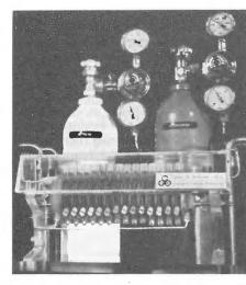
Questa pila a combustibile, del tipo ad idro geno-ossigeno, con elettrodi a base di nichel, funziona a carattere intermittente da un periodo di circa due anni; a tutt'oggi, le prestazioni di questo esemplare si sono mantenute identiche a quelle iniziali, indipendentemente dagli accidenti volontari che sono stati compresi nel programma di prove cui il dispositivo è stato sottomesso. (Documentazione Co.G.E.).
