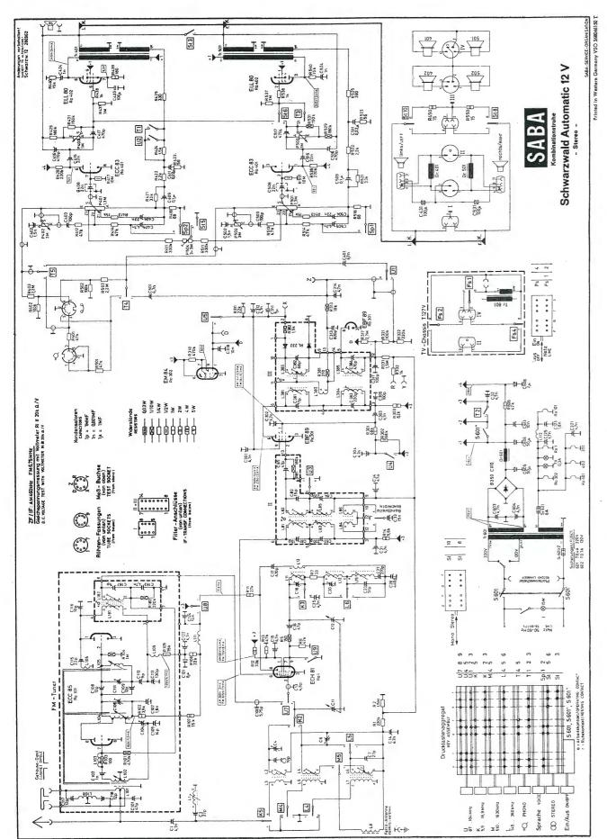
schema elettrico del radioricevitore SABA Mod. Schwarzwald Automatic 12 V
